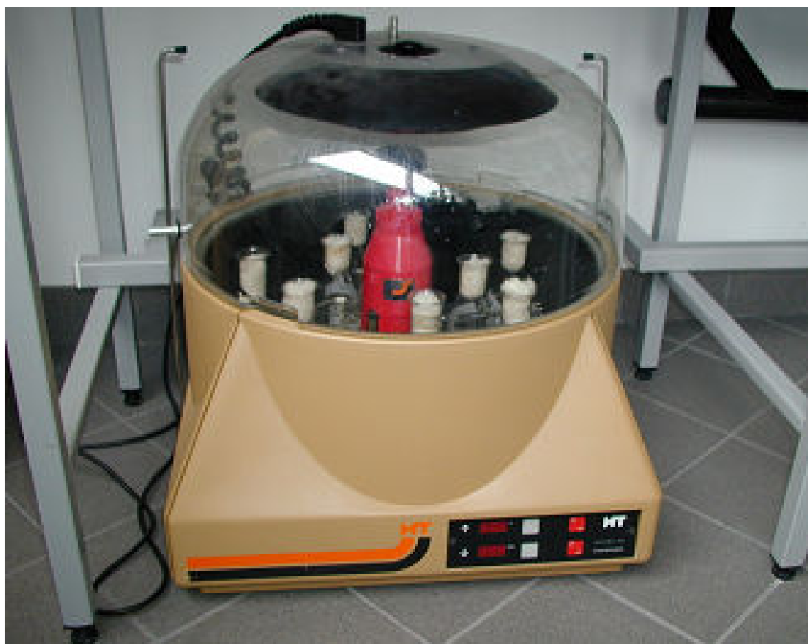
Figure 32: Table d'agitation permettant la culture des micro-organismes.
