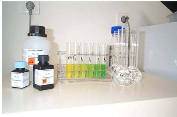
Figure 16 : Solutions étalons pour le dosage de l'azote ammoniacal
