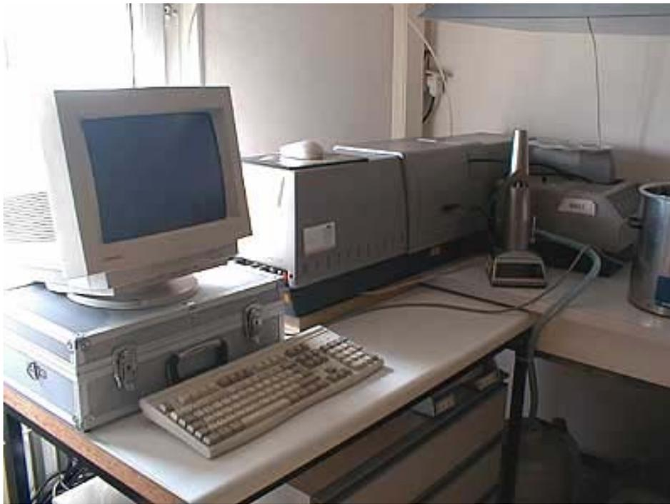
Figure 17 : Granulomètre laser Malvern de type Mastersizer
