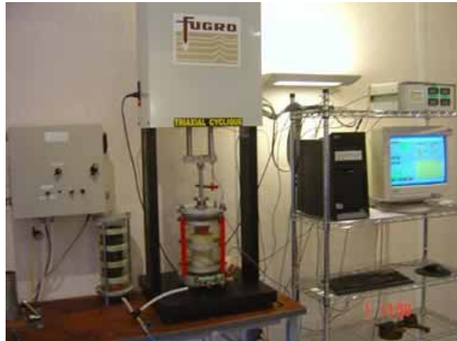
Figure II-11 : Image illustrant la cellule triaxiale utilisée pour les essais cycliques par FUGRO – Paris.
