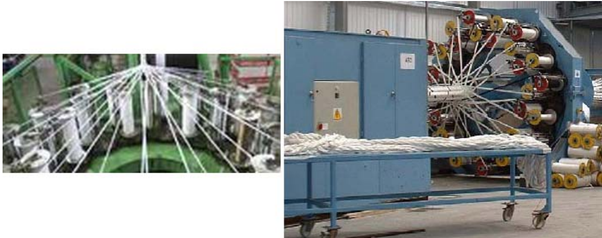
Figure I-4 : Fabrication des câbles. A gauche : assemblage de yarns ; à droite : tressage de la gaine autour du câble.
