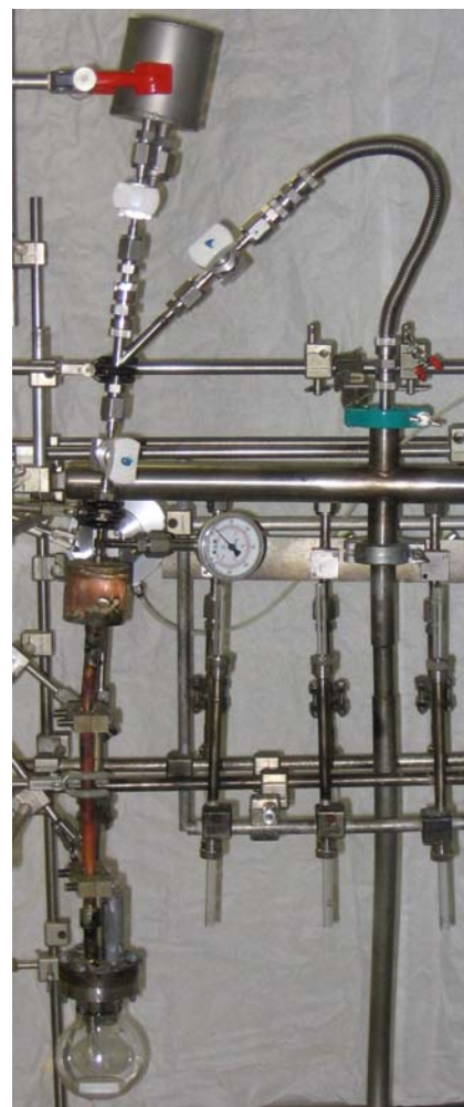
Figure III. 9 : Schéma et photo de la ligne d'extraction de l'hélium dissous des eaux interstitielles des sédiments.
