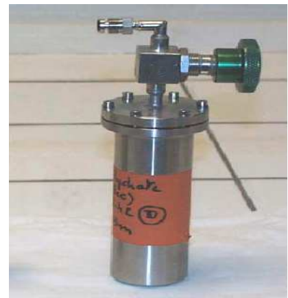
Figure III.1 : Cellule inox étanche dans laquelle un morceau d'hydrate est stocké pour l'analyse des gaz (Charlou et al., 2004)
