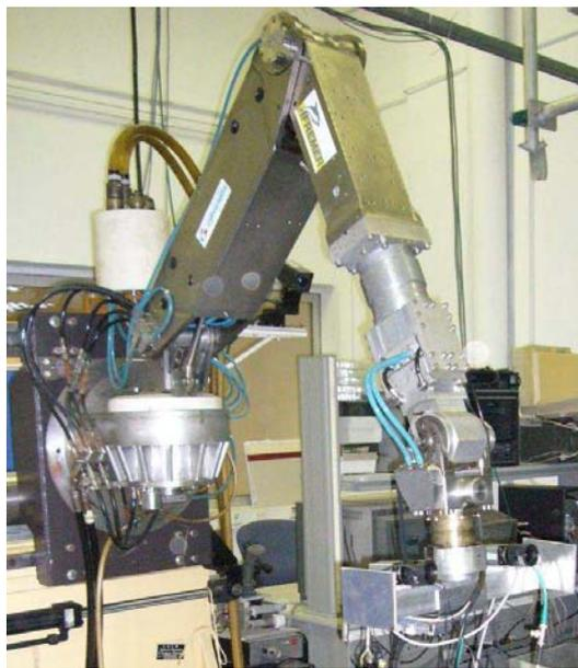
(b) Bras manipulateur hydraulique 6 d.d.l
