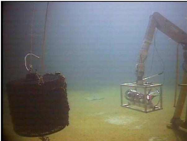
(c) Expérimentation avec le bras manipulateur et IRIS en bassin extérieur
