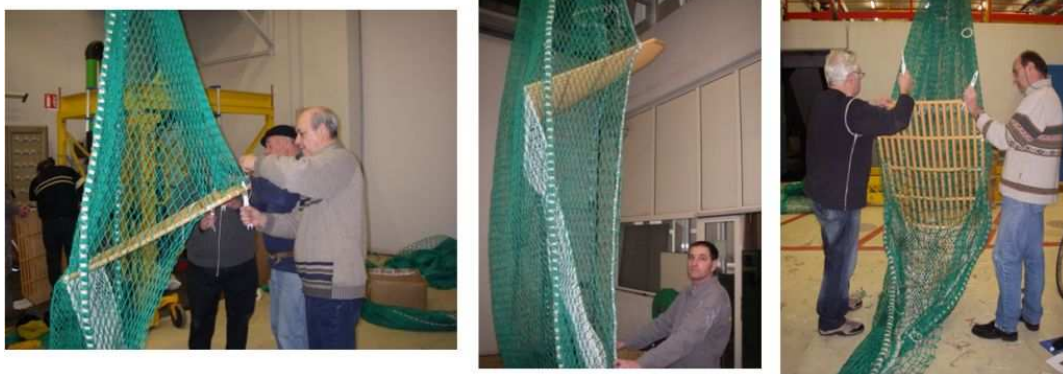
Figure 24 : Illustrations du montage des kits-grilles (Sources : laboratoire LTH de l’Ifremer de Lorient et CRPMEM NPdC/P).
