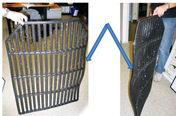
Figure 22 : Déformations observées sur la grille après 5 traits de chalutage (Source : laboratoire RH de l'Ifremer de Boulogne-sur-Mer).
