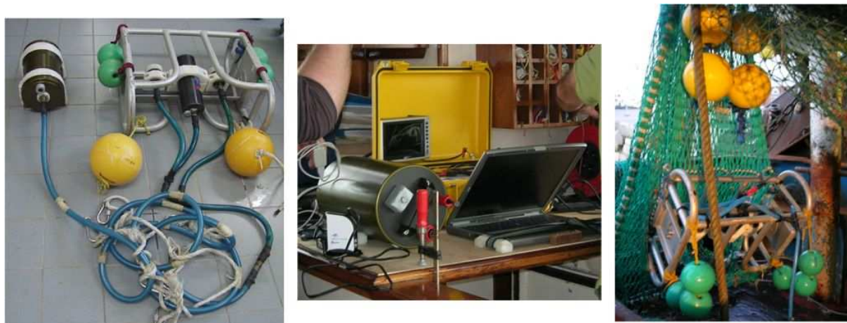
Figure 21 : Raccordement du système VECOC à la caméra et à l'ordinateur et positionnement sur la rallonge (Sources : laboratoire LTH de l'Ifremer de Lorient et CRPMEM NPdC/P).
