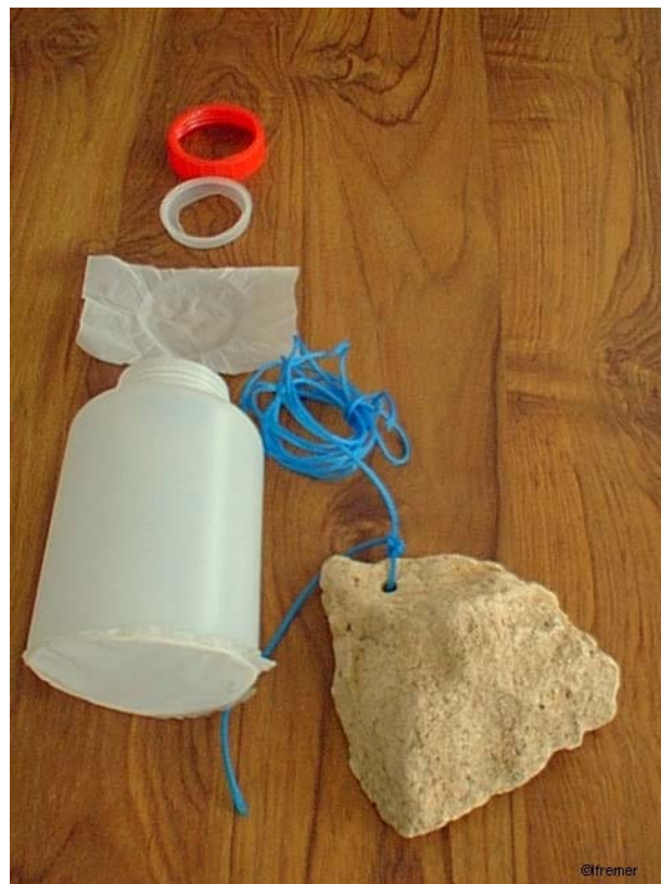
Photographie II-2 : Présentation des différents éléments constituant la chambre utilisée pour réaliser les tests d'embryotoxicité in situ .
