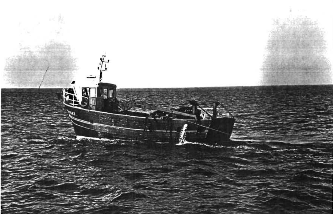
Figure 30. En traction, la flèche ne subit pas de contraintes latérales, les chocs se répercutent sur le treuil, (Photo Ifremer, Arzel).
