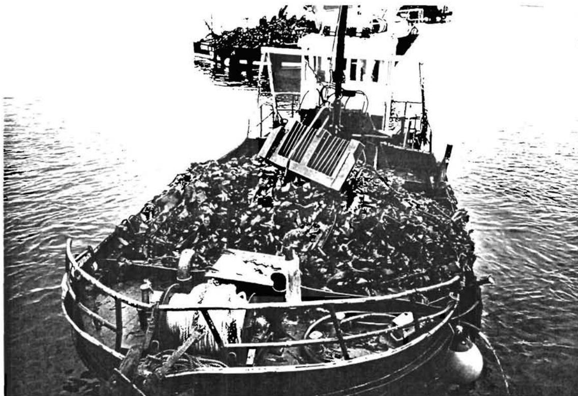
Figure Les bateaux à cabine arrière ont pu s'adapter à la pêche du Laminaria hyperborea , (Photo SBI, Lalande).
