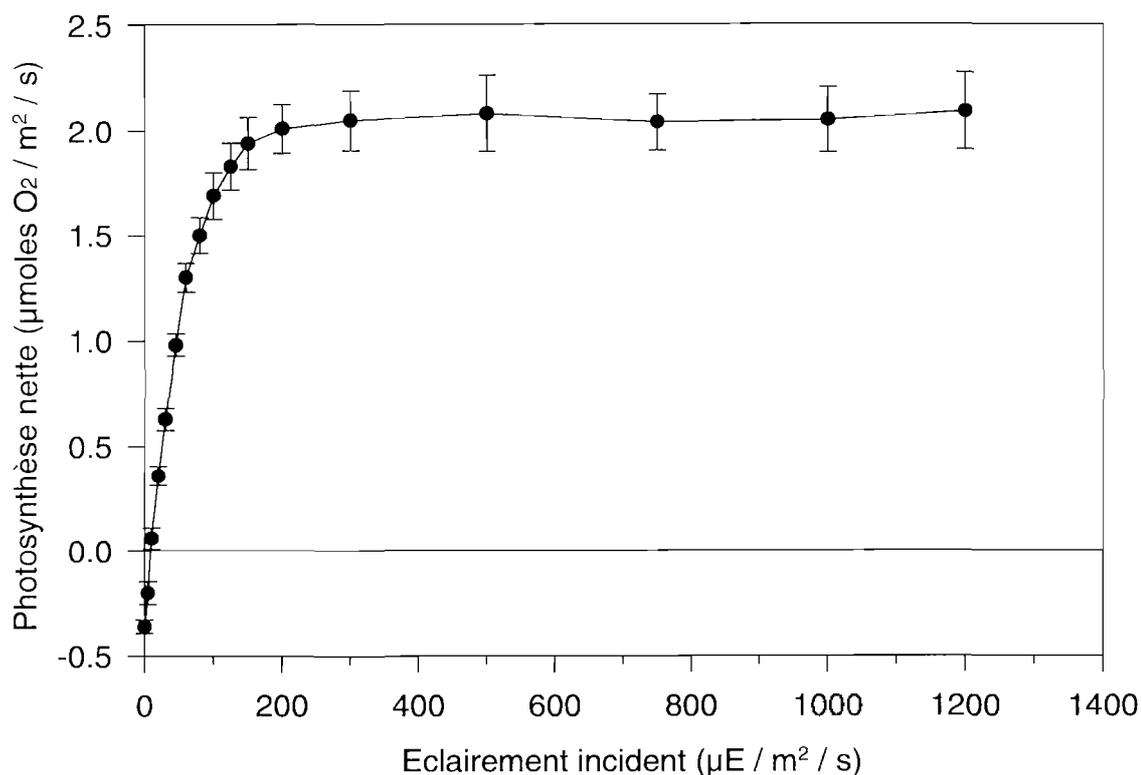
**Figure 45** : Evolution de la photosynthèse nette de *Monostroma obscurum* ( $\mu\text{mol O}_2/\text{m}^2/\text{s}$ ) en fonction de l'éclairage ( $\mu\text{E}/\text{m}^2/\text{s}$ ).
