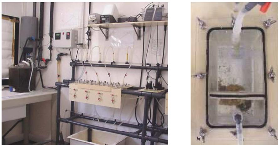
**Figure 18.** Banc d'écophysiologie de la station Ifremer d'Argenton (photo de gauche). Position de l'huître dans l'enceinte (photo de droite) : quelques pseudo-fèces et fèces produits par l'huître sont visibles en haut et en bas, respectivement. Le siphon exhalant est dirigé vers la sortie, le siphon inhalant vers l'entrée. Un système de chicane évite le mélange entre l'eau d'entrée et l'eau de sortie.
