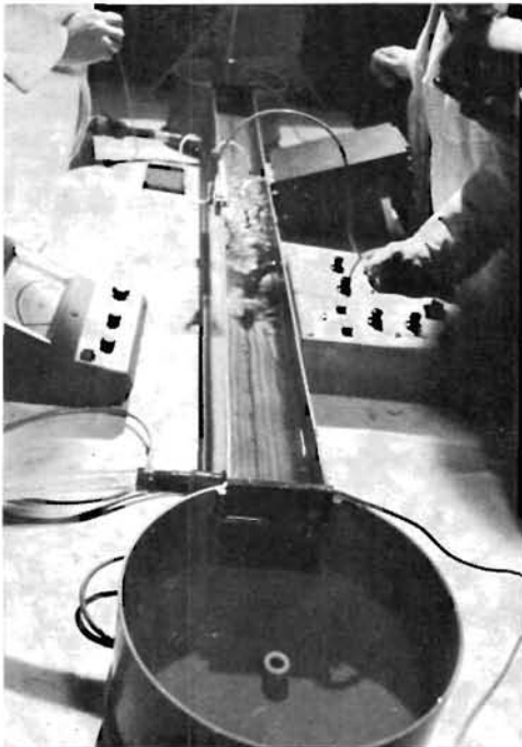
FIG. 2. — Rigole expérimentale utilisée pour la mesure des seuils de taxis et de tétanie ; les extrémités cylindriques servent à recapturer le poisson en fin d'expérience ; pour lui laisser le passage, les électrodes E_1 et E_2 coulissent dans un plan vertical ; A : vue de profil ; B : vue de dessus ; C : variation du potentiel V (trait continu) et du gradient de potentiel \text{Grad}V (tirets) entre les électrodes ; ci-dessous, un mulot se trouve en taxis anodique.
