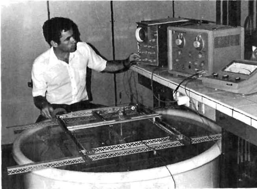
FIG. 32. — Montage expérimental permettant, sur des maquettes, de relever les lignes équipotentiellles pour les différents systèmes d'électrodes étudiés.
