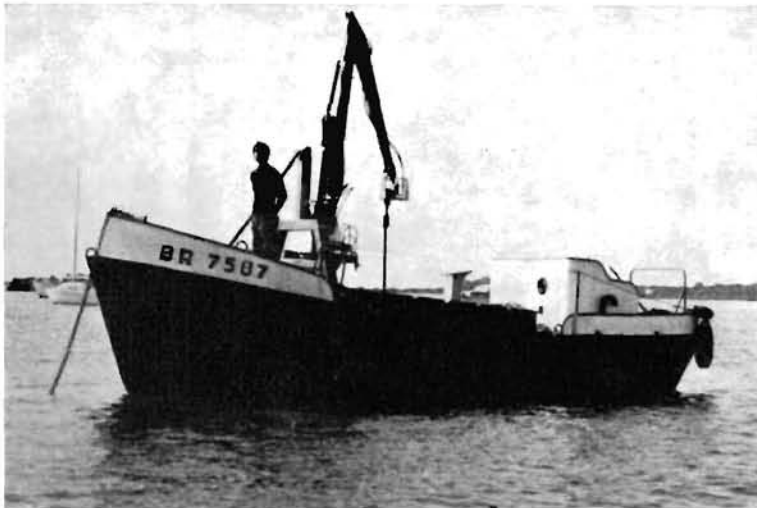
FIG. 1. — Appareillage monté sur le bateau prototype « Jean Ogor ». Le bras mécanique permet, d'une part, la récolte des laminaires lorsqu'on adapte un « scoubidou » à son extrémité, d'autre part, le déchargement des algues sur le quai lorsqu'on remplace le « scoubidou » par un grappin.
