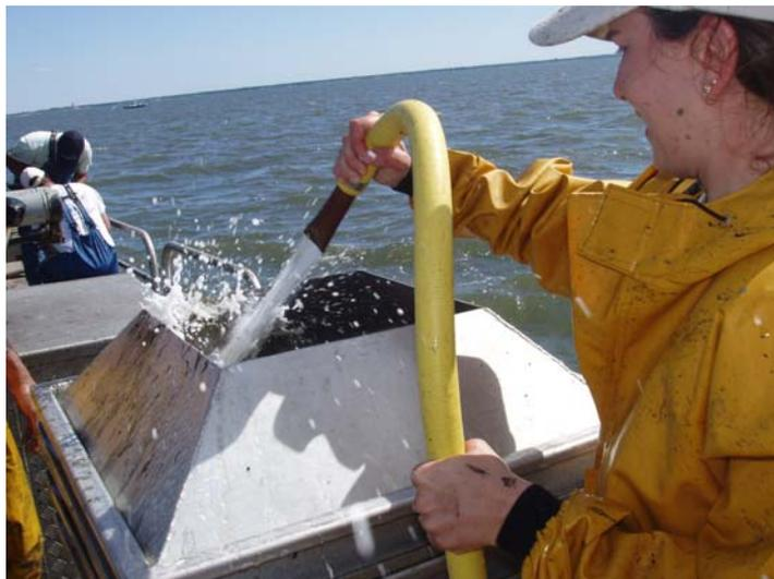
Photo 2 : rinçage et tamisage des prélèvements (utilisation du couvercle)
