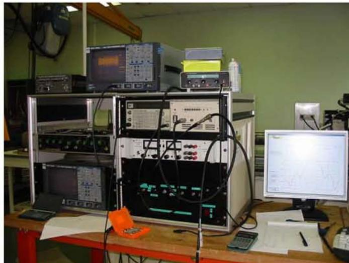
figure 4 : Chaîne de réception de l'hydrophone : amplificateur et oscilloscope .
