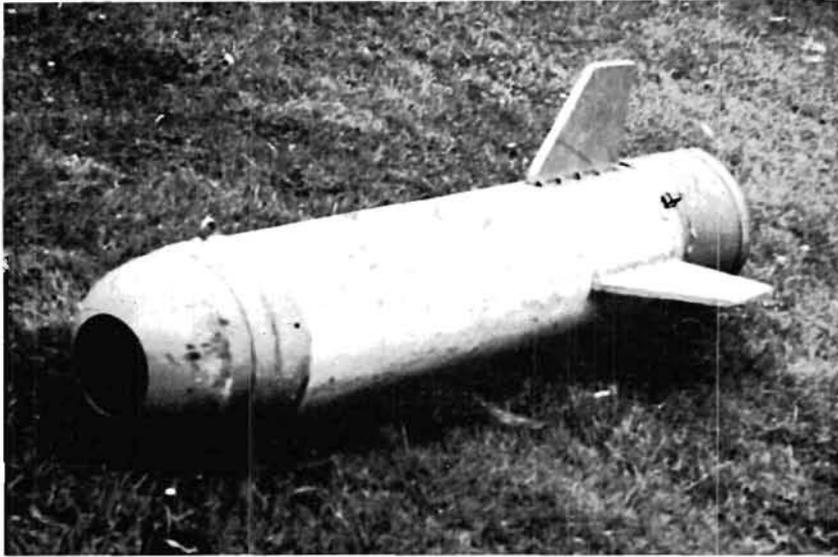
FIG. 2. — *Echantillonneur haute vitesse utilisé pour les prélèvements de plancton.*
