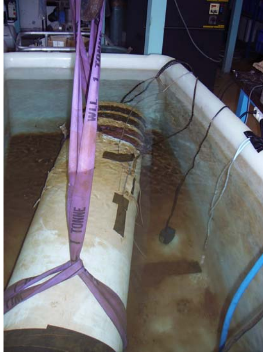
Figure 35 Mise en place du prototype dans la cuve d'eau douce
