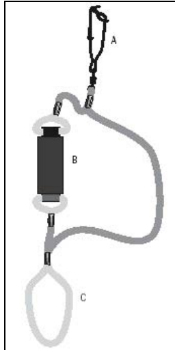
Figure 2.1 : Schéma de montage d'une horloge d'hameçon (A : agrafe, B : horloge, C : boucle d'attache sur l'avançon d'hameçon; le chronomètre se déclenche à partir de quelques kilos de traction, lorsqu'un poisson attaque sur l'appât ; schéma : M.Taquet, 2001)
