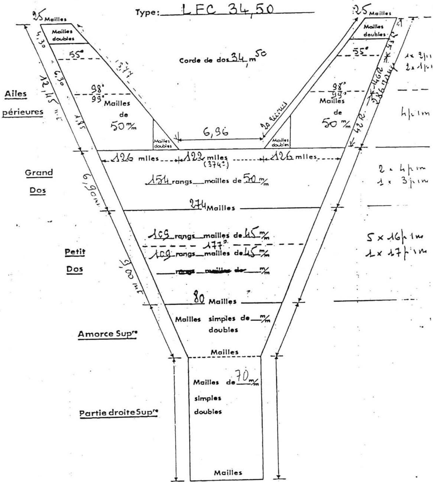
Figure 3 : Plan du chalut utilisé à bord du navire martiniquais kayali.
