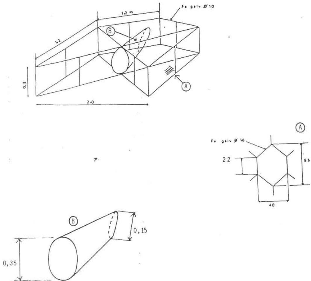
Figure 2 : Type de nasse utilisée à bord des ligneurs vénézuéliens et à bord de la V/O POLCA, (juin-juillet 1988).
