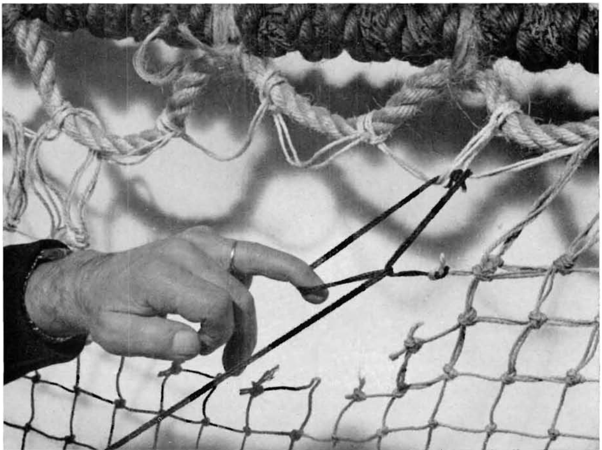
FIG. 72. — Réalisation de la grande maille sur une maille franche. A mesure de la grande maille avant la construction.
