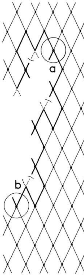
FIG. 48. — Déchirure sur une bordure tout en mailles de côté et s'étendant à l'intérieur de l'alèze. A une maille franche fait suite à la maille de côté non détruite, a et b pattes de départ et de finition en ramendage continu; B une patte fait suite à la maille de côté non détruite, ramendage en deux temps : a et b pattes de départ et de finition du premier temps; c et d pattes de départ et de finition du deuxième temps.
