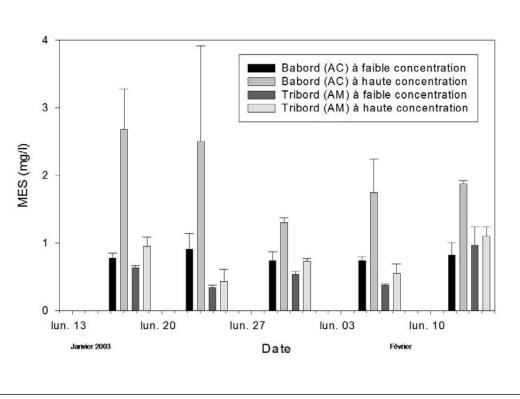
Figure 24. Evolution de la concentration de la matière totale en suspension (MES) en sortie des bassin d'élevage (forte concentration) et dans la boucle de traitement (faible concentration) des systèmes expérimentaux alimentés avec l'aliment conventionnel (Bâbord) et l'aliment modifié (Tribord). Moyenne  $\pm$  écart type
