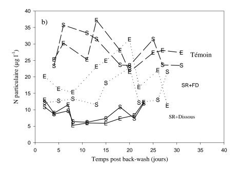
Figure 17. Évolution des concentrations en carbone (C) et en azote (N) particulaires à l'entrée (E) et à la sortie (S) du filtre biologique pour trois conditions de fonctionnement : 1) Utilisant une filtration diatomées pour éliminer les particules dans la boucle (SR+DF), 2) Utilisant des sources dissoutes de C organique et d'azote inorganique à la place des produits métaboliques de poisson (SR+Dissous) et, 3) Témoin.
