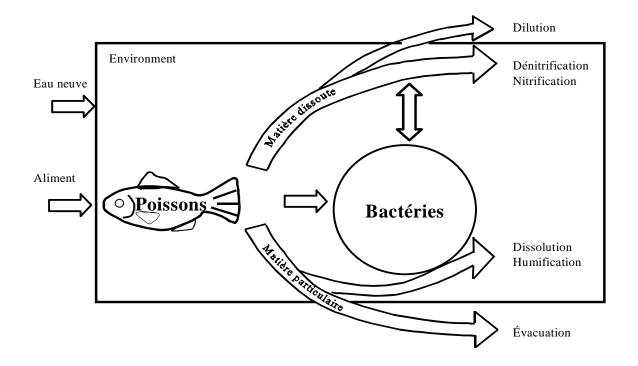
Figure 2. Modèle du fonctionnement du système de recirculation aquacole représentant les compartiments suivants : 1) Poissons, 2) Matière dissoute, 3) Matière particulaire, 4) Bactéries.
