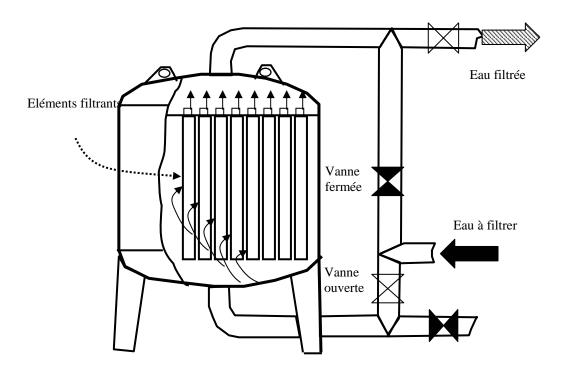
Figure 16. Schéma de fonctionnement du filtre FOURNIER au cours de la filtration.
