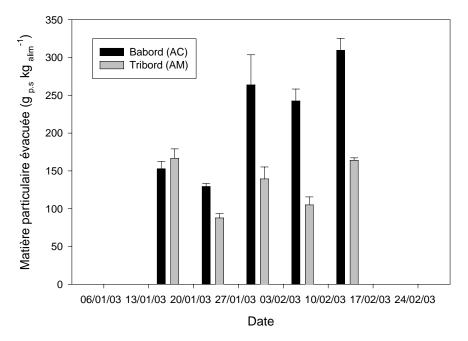
Figure 27. Evacuation de la matière particulaire par la filtration mécanique des systèmes recirculés alimentés avec un aliment conventionnel (Bâbord) et un aliment modifié (Tribord). Moyennes ± écart type en g poids sec par kg d'aliment distribué.
