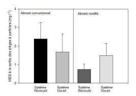
Figure 26. Concentration (moyenne ± écart type) de matière totale en suspension (MES) à la sortie des pièges à particules en fonction du type d'aliment utilisé (conventionnel ou modifié) et en fonction du type de système d'élevage (recirculé ou ouvert).
