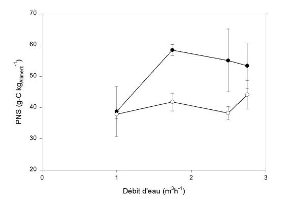
Figure 13. Production nette de carbone particulaire (PNS) par le bassin d'élevage en fonction du régime hydraulique, durant les expériences avec deux tailles de bar (64-93g-○ et 512-591g-●). Valeurs moyennes et écart-type.
