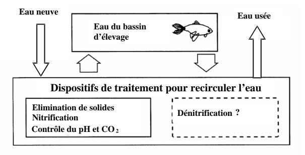
Figure 1. Modèle simplifié du système de recirculation aquacole
