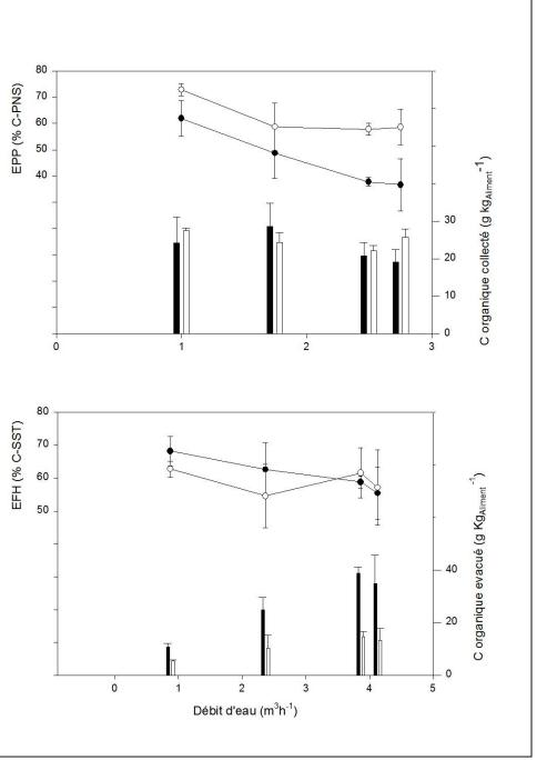
Figure 14. Efficacité des pièges à particules (EPP) et du filtre mécanique (EFH) en fonction du régime hydraulique, durant les expériences avec deux tailles de bar (64-93g-? et 512-591g-?). Les histogrammes représentent la quantité de carbone organique évacué ou collecté respectivement par les pièges à particules et le filtre mécanique.
