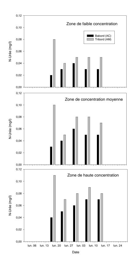
Figure 22. Evolution de la concentration d'urée (N-Urée) près des bassin d'élevage (forte concentration), dans la boucle de traitement (concentration moyenne) et à l'arrivée des bassins (faible concentration) des systèmes expérimentaux alimentés avec l'aliment conventionnel (Bâbord) et l'aliment modifié (Tribord). Moyenne ± écart type.
