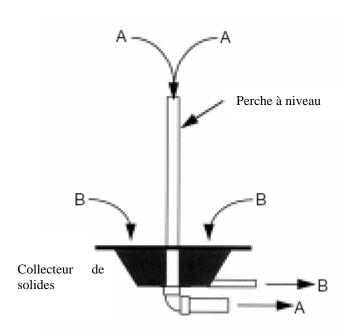
Figure 3. Double sortie centrale utilisée pour concentrer les solides du bassin d'élevage. A= effluent de solides en suspension, B= Sortie de solides sédimentables. (D'après Losordo *et al.*, 1999).
