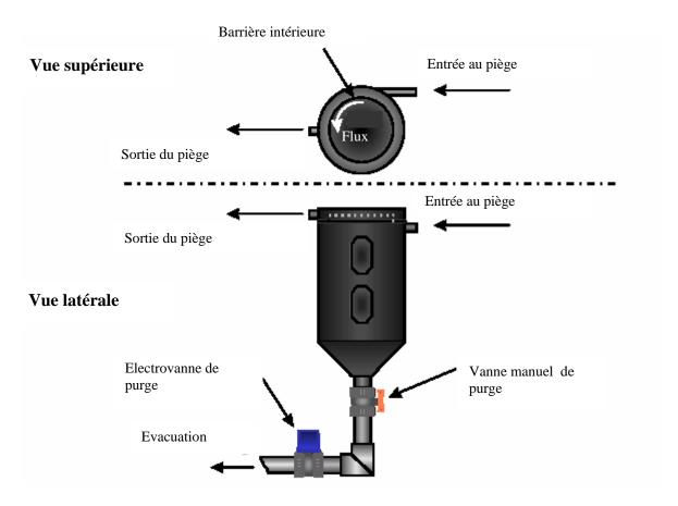
Figure 4. Piège à particules utilisée dans le système ECO-TRAP 300 (AquaOptima AS, Trondheim, Norway).
