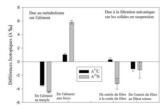
Figure 9. Différences des signatures isotopiques ( $\Delta^{13}$ C et  $\Delta^{15}$ N) sur la matière particulaire entrant et sortant dans les deux principaux processus de transformation où elle participe dans le système de recirculation. Les barres représentent les différences isotopiques obtenues pour l'ensemble des données des trois évaluations. Les barres d'erreur correspondent aux erreurs-type de la différence entre les deux moyennes en question.
