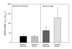
Figure 25. Collecte de matière particulaire en fonction du type d'aliment utilisé (conventionnel ou modifié) et en fonction du type de système d'élevage (recirculé ou ouvert). Moyenne journalière par kg d'aliment distribué ± écart type.
