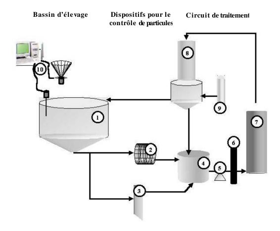
Figure 7. Système de recirculation expérimental: 1) Deux bassins d'élevage de 2m³ (un seul figure sur ce schéma), 2) Filtre à tambour HYDROTECH (30µm), 3) Pièges à particules, 4) Bac tampon avec résistance chauffante et unité de contrôle de pH, 5) Pompe de recirculation, 6) Unité de désinfection-UV, 7) Filtre biologique nitrifiant (0,7m³), 8) Bac de charge équipé d'une colonne de dégazage, 9) Unité d'injection d'oxygène, 10) Système d'auto alimentation.
