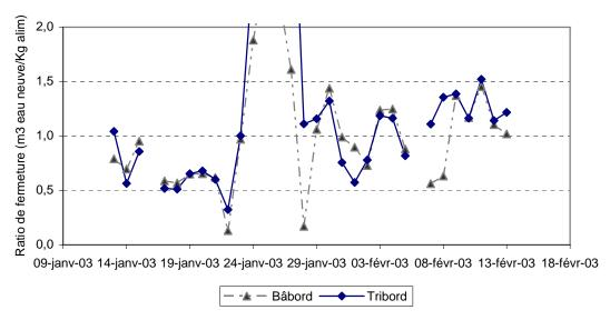
Figure 19. Evolution des taux de fermeture des circuits expérimentaux qui utilisaient un aliment conventionnel (Bâbord) et un aliment modifié pour augmenter la collecte des fèces (Tribord).
