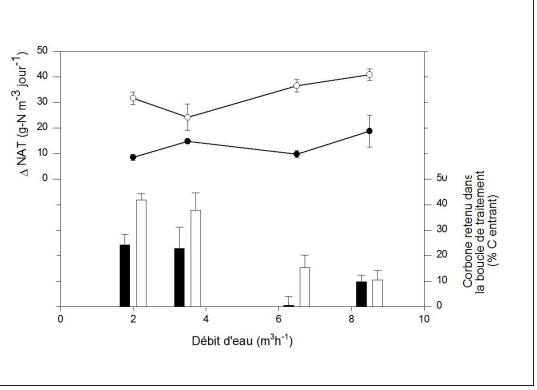
Figure 15. Performance de la filtration biologique (Δ NAT) et carbone particulaire retenu dans la boucle de traitement (%, par rapport à l'arrivant) en fonction du régime hydraulique, durant les expériences avec deux tailles de bar (64-93g-○ et 512-591g-●).
