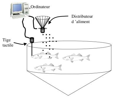
Figure 6. Système d'auto-alimentation opéré par les poissons (d'après Covès et al., 1998)
