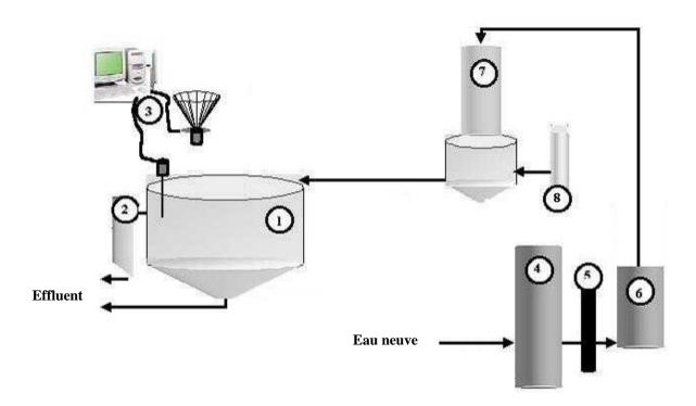
Figure 8. Système d'élevage avec pré-traitement d'eau (système ouvert). 1) Deux bassins d'élevage de 2m³ (un seul est montré), 2) Pièges à particules, 3) Système d'auto alimentation, 4) Filtre à sable, 5) Unité de désinfection-UV, 6) Unité de contrôle de température, 7) Bac de charge équipé d'une colonne de dégazage, 8) Unité d'injection d'oxygène.
