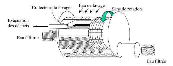
Figure 5. Fonctionnement d'un filtre à tambour rotatif
