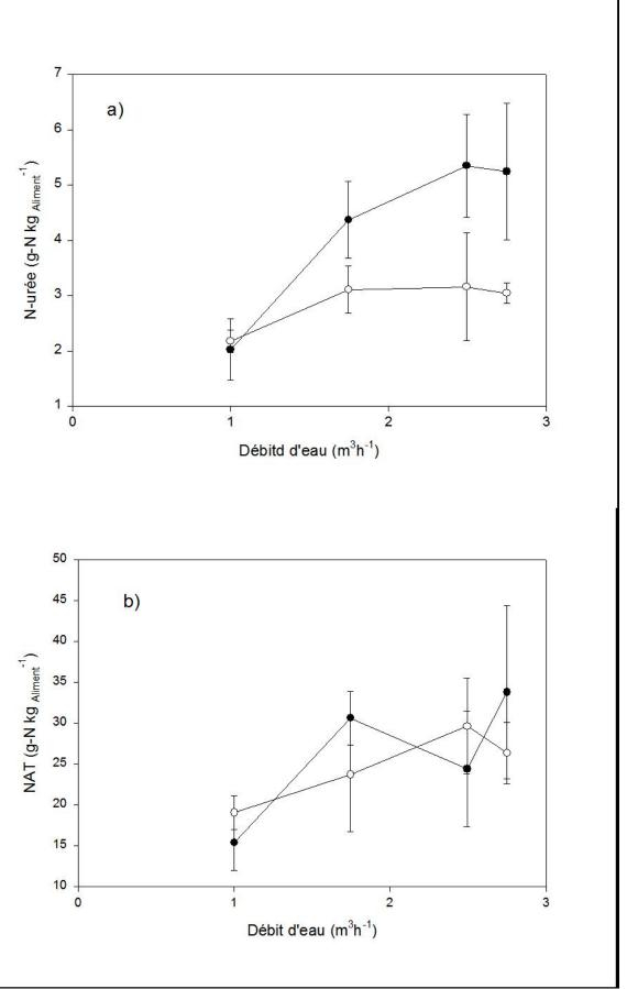
Figure 12. Production d'urée (a) et NAT (N-NH<sub>3</sub>+N-NH<sub>4</sub>) par le bassin d'élevage du système de recirculation (b) en fonction du régime hydraulique, durant les expériences avec deux tailles de bar (64-93g-○ et 512-591g-●). Valeurs moyennes et écart-type.
