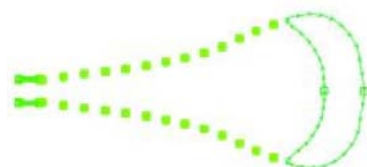
Figure 3.1: Géométrie considérée comme modèle de filet 2D et axisymétrique
