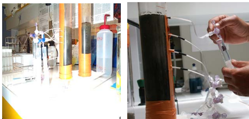
Figure 12 Extraction des eaux interstitielles à l'aide de rhizons
