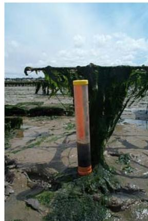
Figure 11 Carottier de prélèvement in situ contenant le sédiment extrait en vue du dosage
