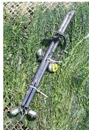
Figure 10. Sondes thermiques mises en place sur une perche, et positionnées en surface et à 15 cm dans le sédiment (2 sondes par niveau).
