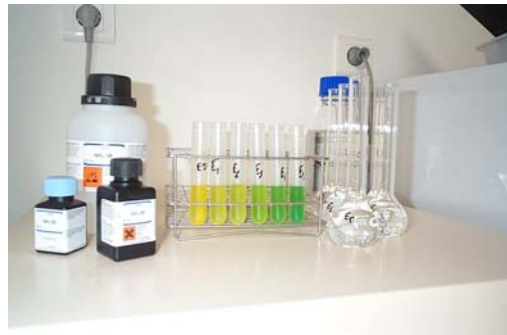
Figure 13. Réactifs et exemple de coloration sur les solutions étalons pour le dosage de l'ammonium
