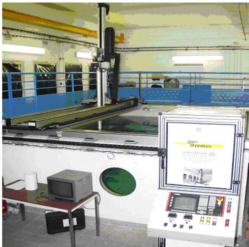
FIG. 5.10 – Le portique PISCATOR sur le bassin d'essai.
