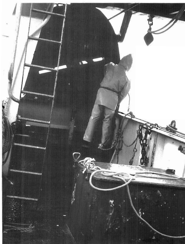
Photo 4 - Poste de travail au panneau non conforme.
