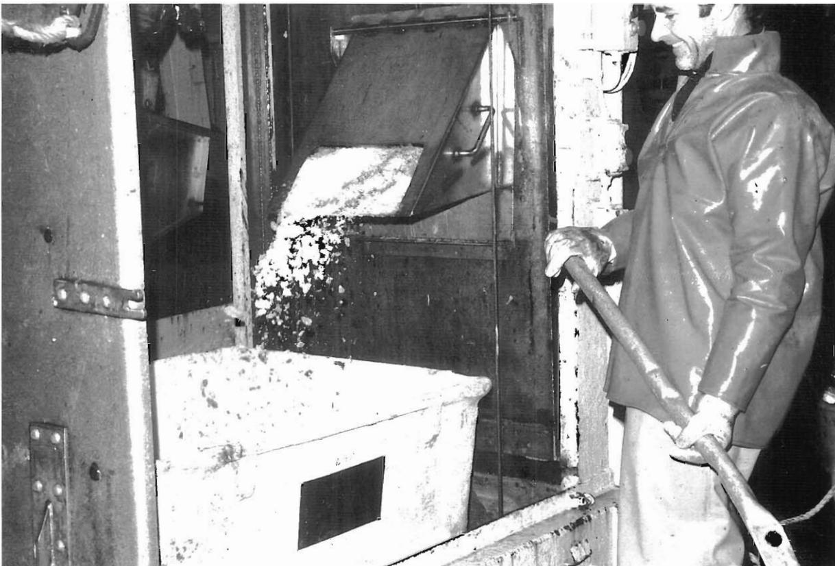
Photo 12 - Poste de remplissage des conteneurs dans la salle de travail d'un chalutier industriel de pêche fraîche.
