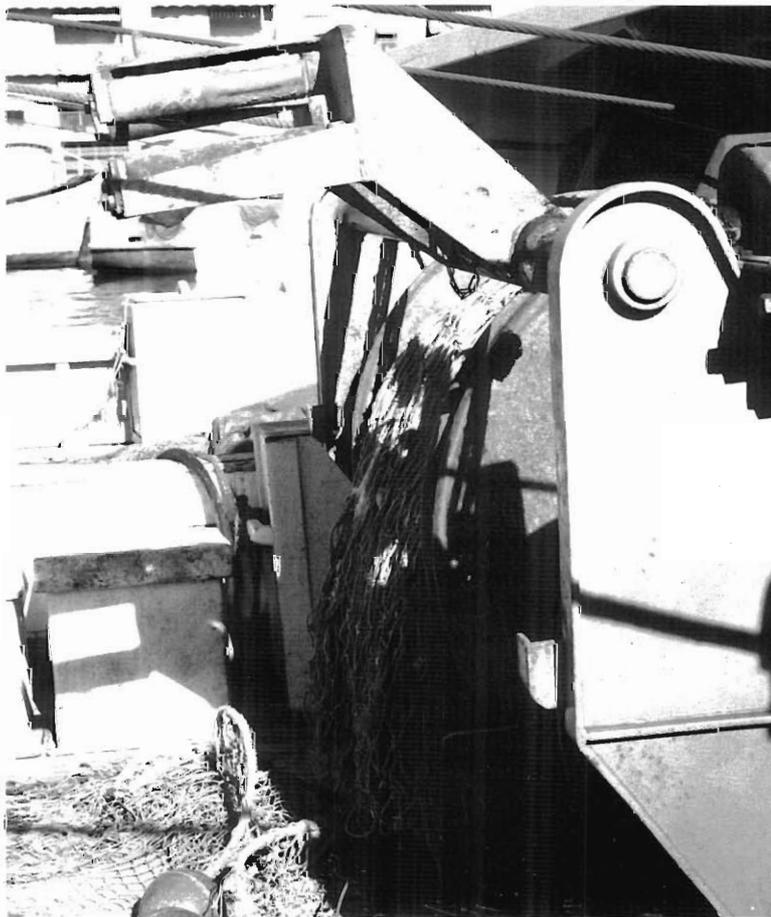
Photo 10 - Guide-câble en position relevée.
