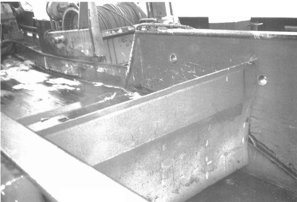
Photo 8 - La porte pivotant autour d'un axe horizontal.
