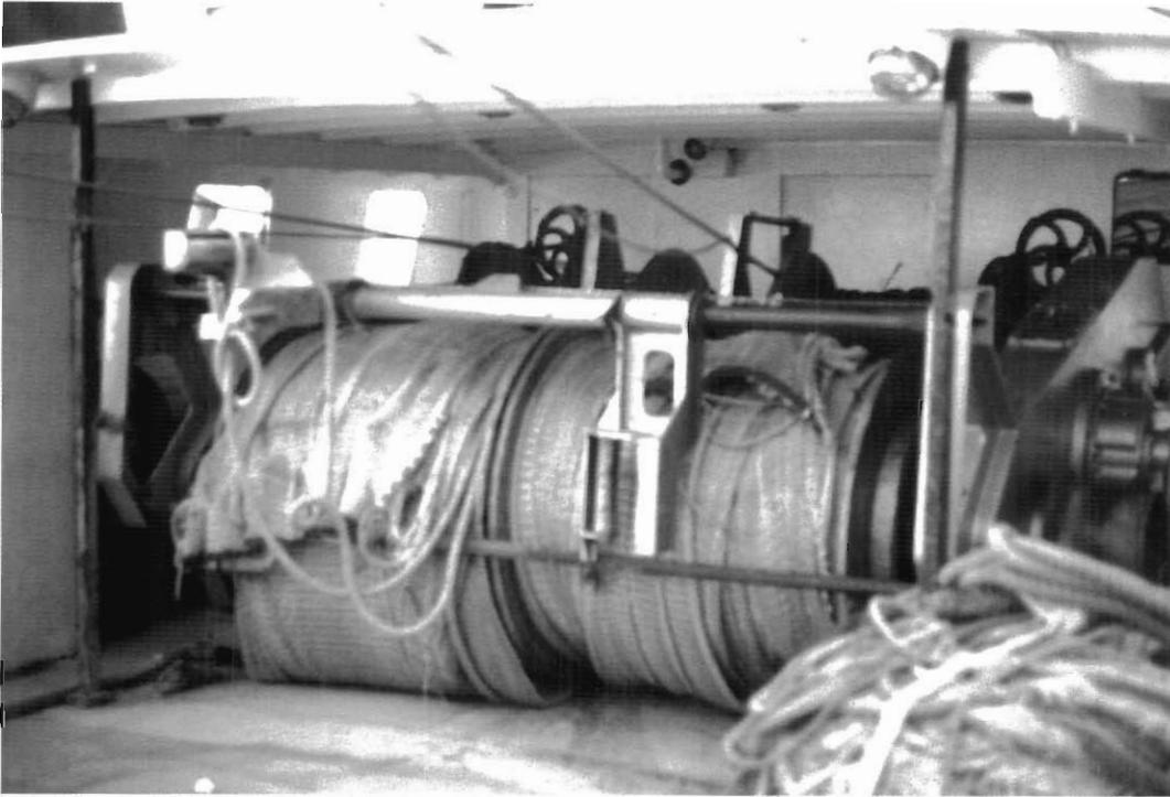
Photo 9 - Guide-câble en position abaissée.
