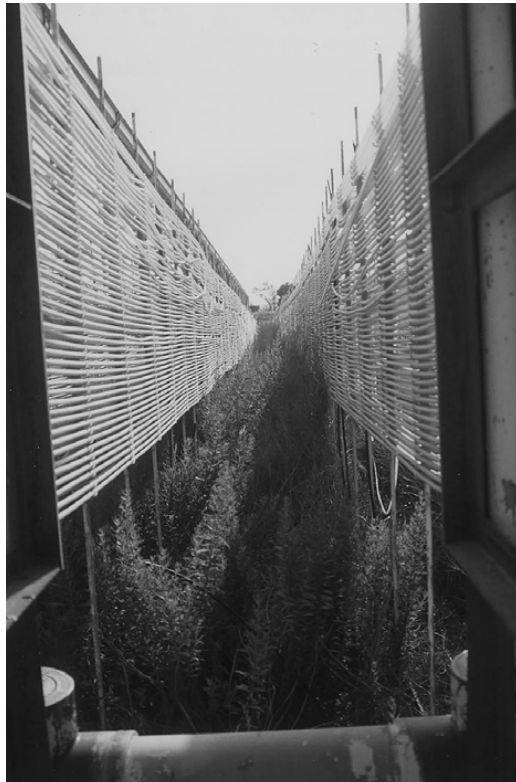
Figure II.8 : Installation du photobioréacteur industriel de la société Photo Bioreactors Ltd. en Espagne (Tredici 1999).
