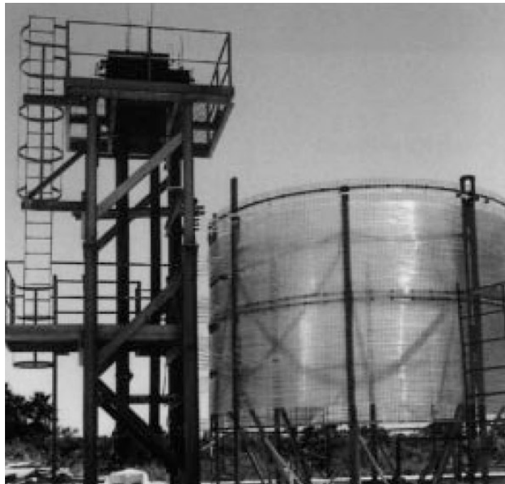
Figure II.7 : Photobioréacteur « Biocoil » (Richmond 2000) inventé par Lee Robinson (brevet européen n° EP 0239272, 6 mars 1987).
