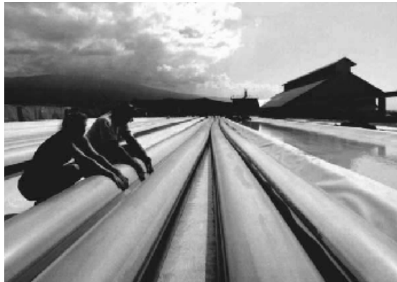
Figure II.28 : Mera Growth Module, un photobioréacteur de 25 000 l composés de tubes de 120 m de long et 25,5 cm de diamètre installé à Hawaii (Etat Unis) (Olaizola 2000; 2003).
