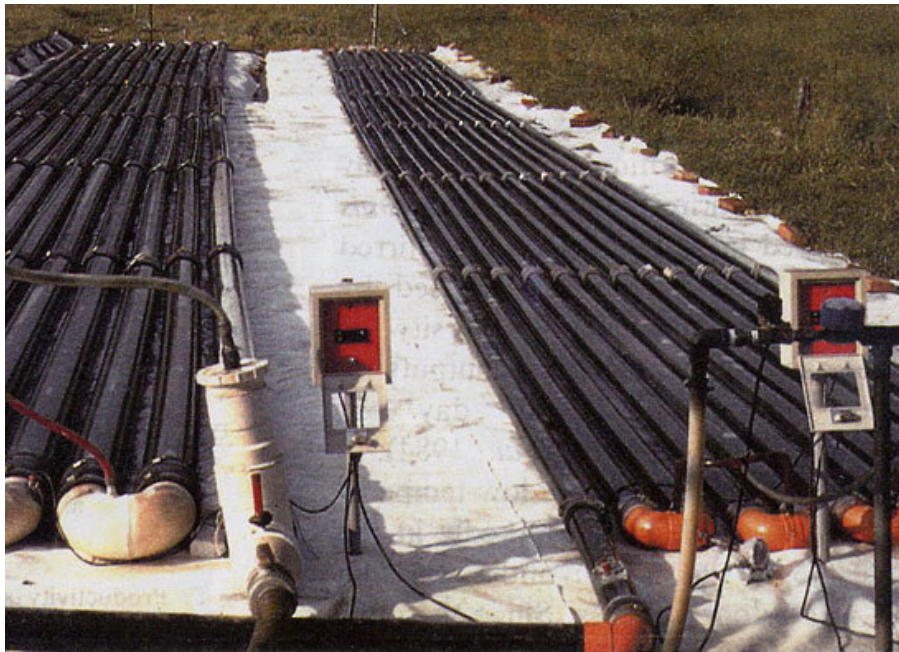
Figure II.10 : Photobioréacteur tubulaire pour la culture de Spirulina spp. en extérieur utilisant une surface réfléchissante (Tredici et Materassi 1992).
