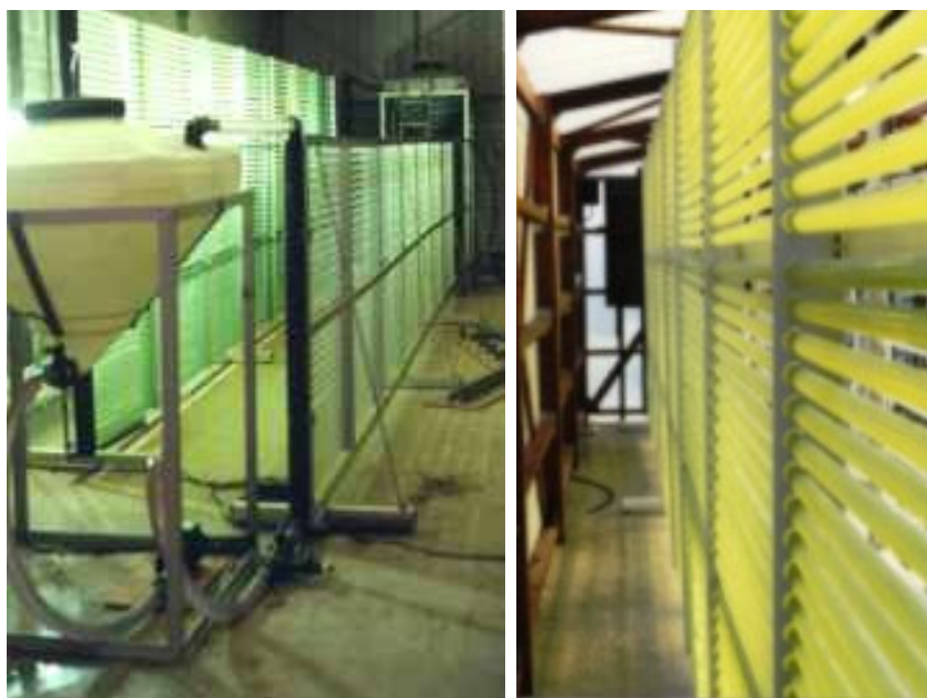
Figure II.27 : Le photobioréacteur « Cell Pharm Tubular reactor (Bio-Fence) » de 400 litres (à gauche) et de 600 litres (à droite) (Cell Pharm Bioactive Product http://home.bt-webworld.com/cellpharm/ ).
