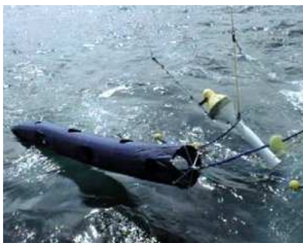
Figure III.8 : La bouée Carioca et son ancre flottante (en bleu)
