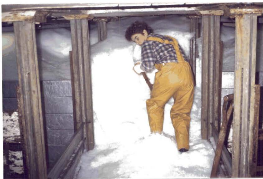
Photo 8 : Préparation de la cale : mise en place des planches et du "fond de cale"
