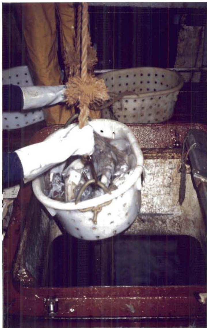
Photo 6 : Descente du panier en cale à l'aide du palan manuel
