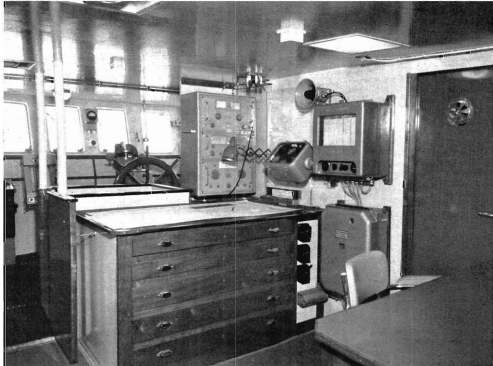
FIG. 3. — La chambre des cartes : sont visibles le meuble à cartes, la radio, l'appareil de navigation Decca et le sondeur Tietzelot.
