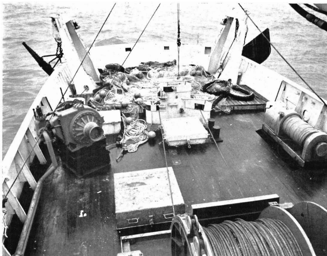
FIG. 4. — La plage arrière : au premier plan le treuil de pêche (de la bobine bâbord, seule une flasque est visible), côté tribord le treuil de bras de senne, à l'arrière-plan les potences en position de chalutage (le rouleau amovible n'est pas en place). Le treuil du Netzsonde, à bâbord, n'est pas à sa place laquelle est prévue sur le pont supérieur.
