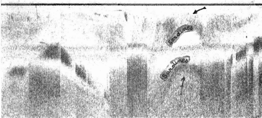
FIG. 7. — Détection horizontale à 30 m d'un canot porte-feu équipé d'un réflecteur émergé de 2 500 w. Noter les échos de sardines sur le pourtour du canot, à la limite de la zone éclairée. Il s'agit d'une conduite typique de photopréférendum chez les sardines adultes.
