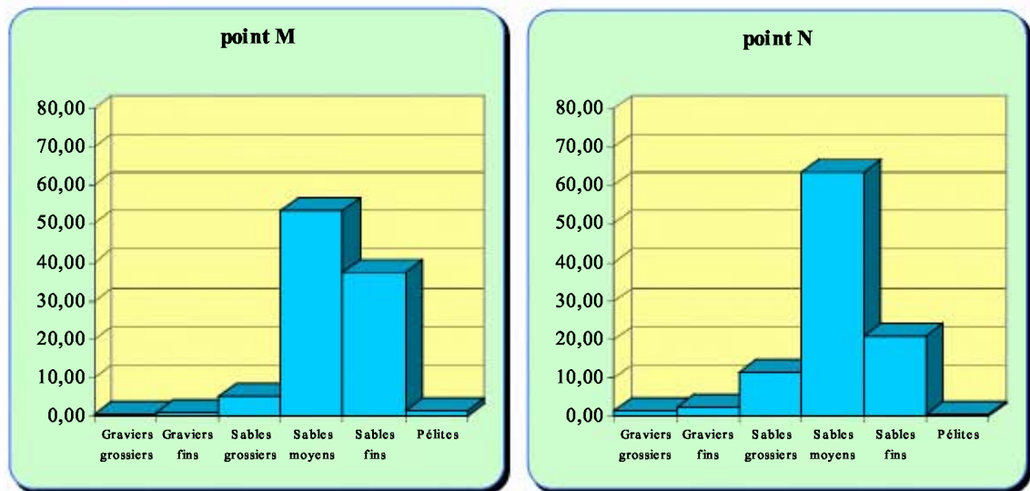
Figure 7.3. Radiale 3, Caractéristiques granulométriques du sédiment (% pondéraux)
