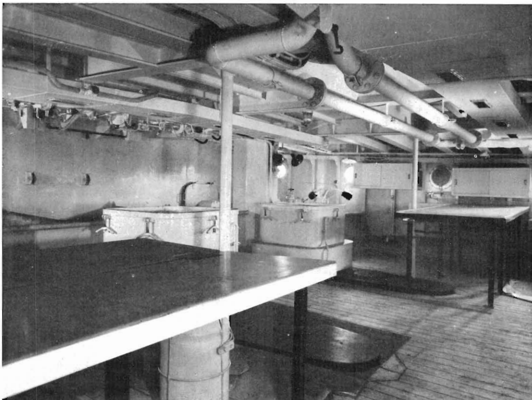
FIG. 10. — Un secteur du laboratoire-salle de tri du poisson, les hiloires des deux viviers sont visibles à l'arrière plan
