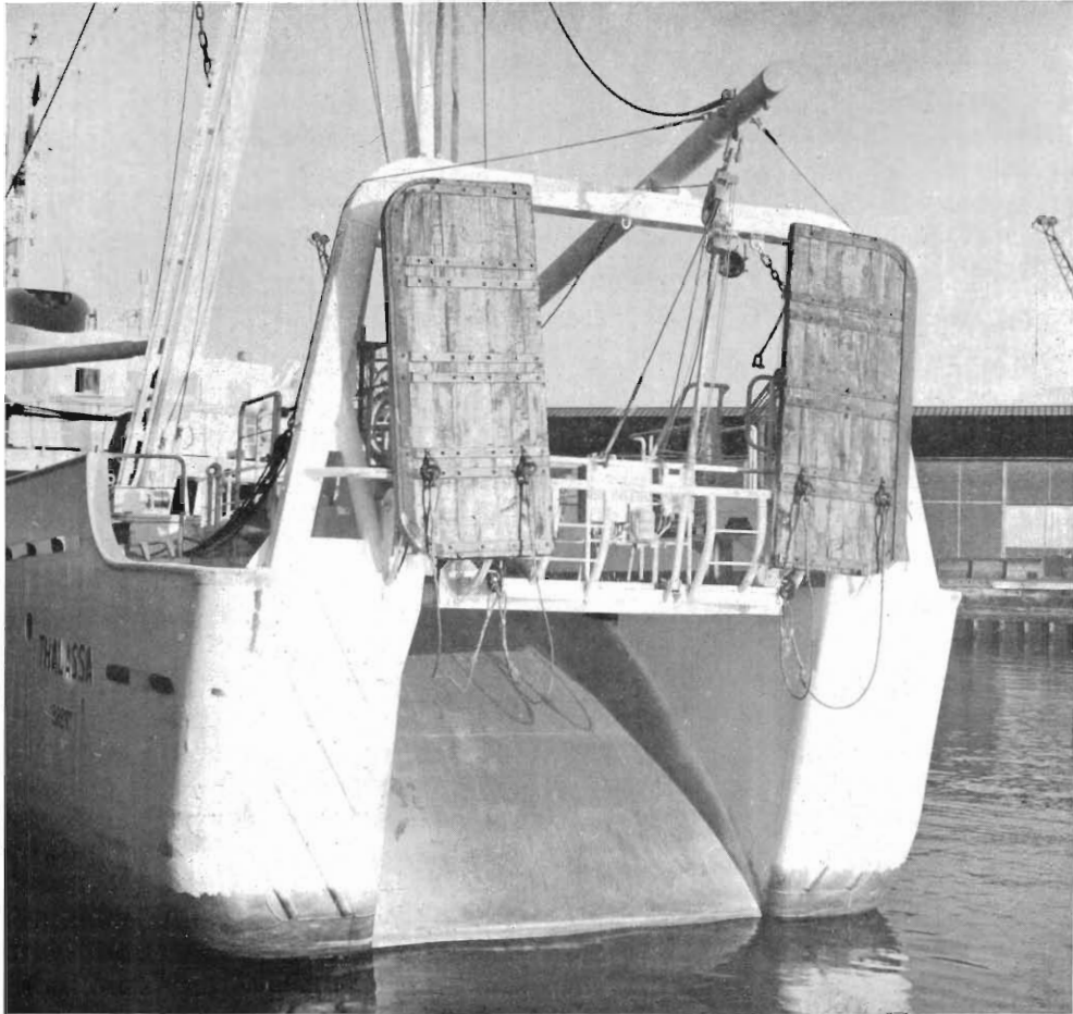
FIG. 3. — La rampe arrière et son portique sur lequel sont accrochés les panneaux de chalut
