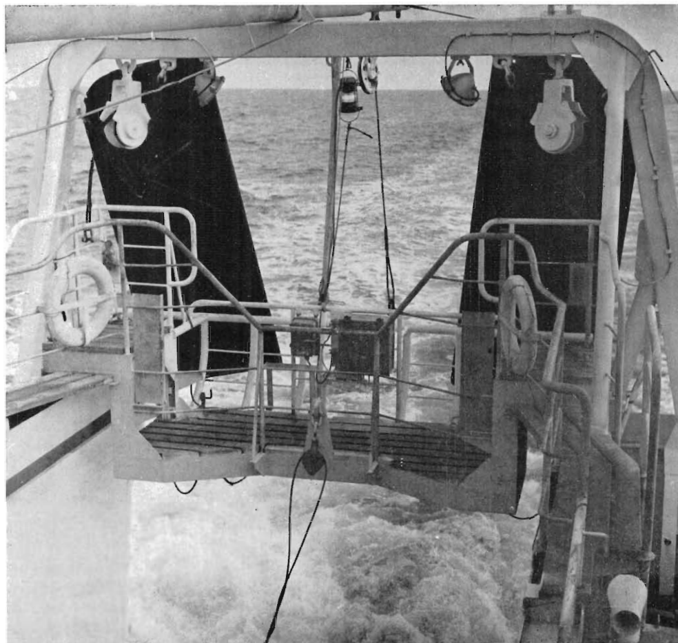
FIG. 4 — Le portique et la petite passerelle surplombant la rampe arrière, sur la cloison, à gauche de la figure, la gouttière dans laquelle glisse l'un des réas de guidage des funes.
