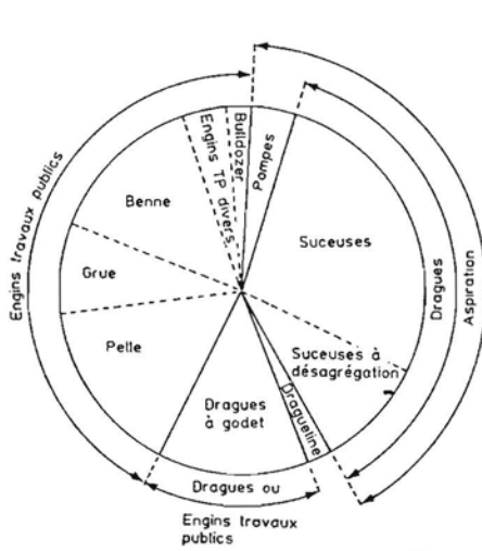
Figure 16 - Moyens de dragage utilisés dans les ports de plaisance. d'après D. Robbe 1989
