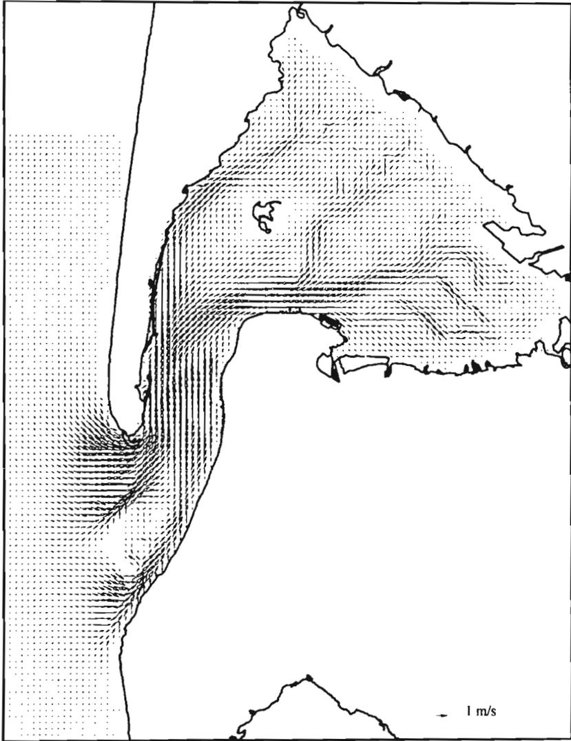
Figure 16 : Vitesses maximales de flot (Coefficient 90)
