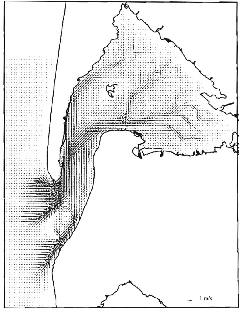
Figure 17 : Vitesses maximales de jusant (Coefficient 90)
