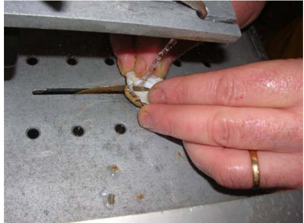
Figure 11 : Une coupe de chaque valve est réalisée à l'aide d'une scie à roche
