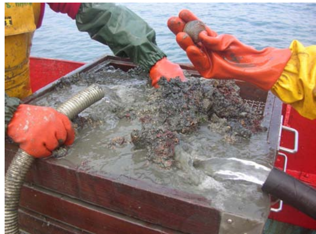
Figure 6 : Le tri s'effectue à l'aide de 3 tamis de 20, 15 et 5 mm, l'eau, indispensable, permet d'évacuer la vase et de laver le maërl, principal faciès sédimentaire rencontré lors de la mission
