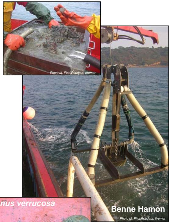
Prélèvement de 0,25 m<sup>2</sup> de sédiment à chaque station avec la benne Hamon
