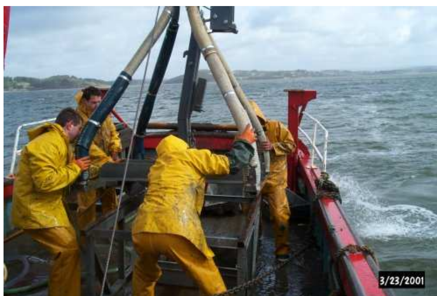
Installation de la benne sur le socle.
