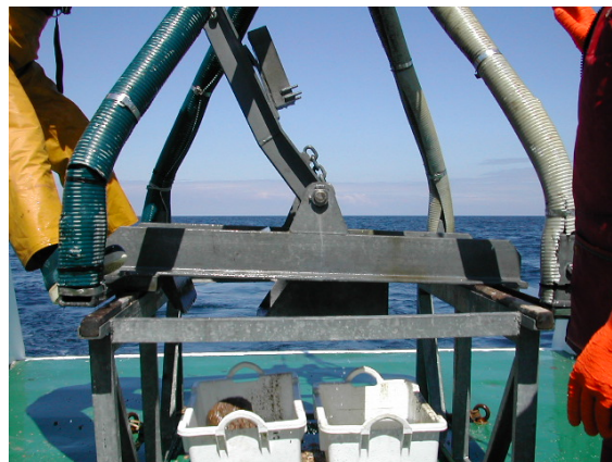
Prélèvement de sédiment à l'aide de la benne Hamon
