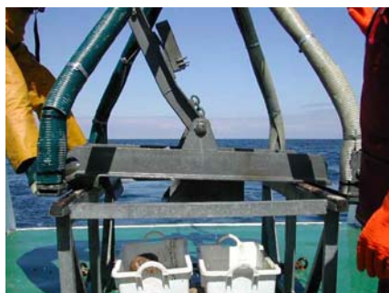
Figure 2 : Ouverture du godet de la benne Hamon
