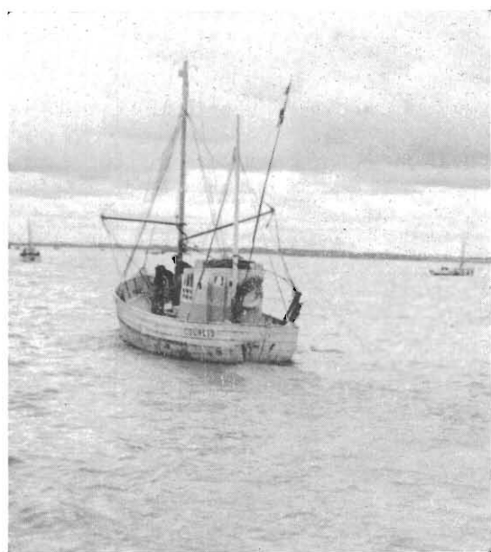
FIG. 5 — Bateau équipé d'un treuil et de tangons
