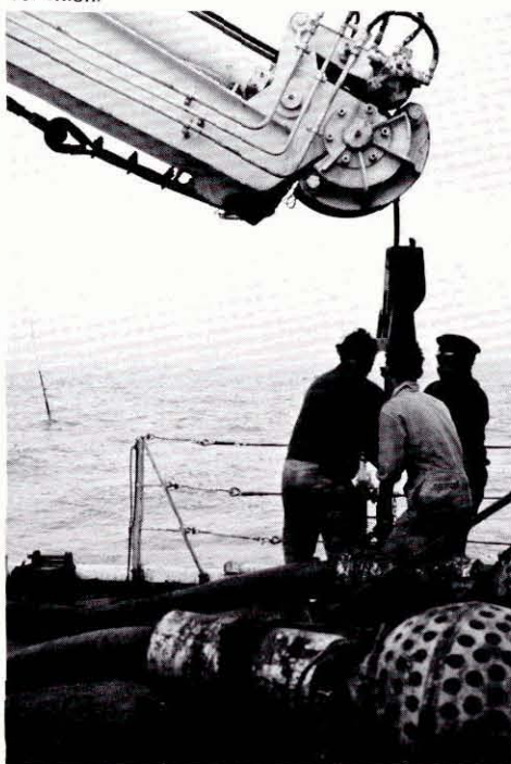
Mise en œuvre de bouées-relais pour sismique-réflexion.
