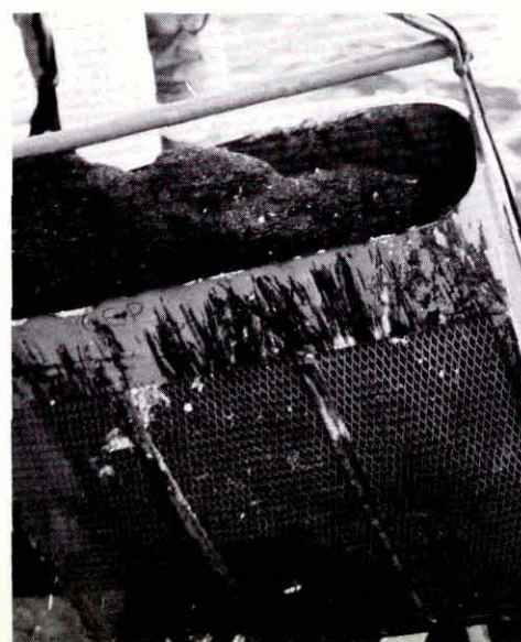
Prélèvement expérimental de nodules polymétalliques - Remontée d'une drague.
