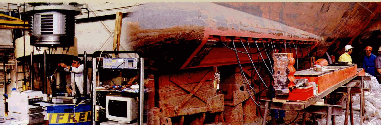
► Essai de comportement en pression d'une enceinte cylindrique
