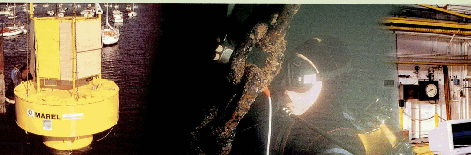
► Bouée MAREL (Mesure automatique en réseau pour l'environnement côtier)
