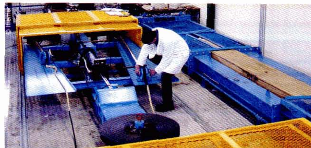
Test de comportement d'un câble synthétique en traction avec passage sur poulie.
