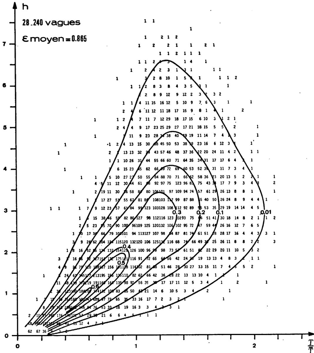
Fig. 1. — Densité de probabilité composée expérimentale.
