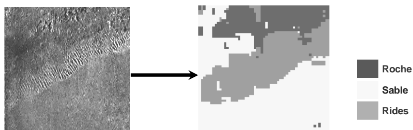
Fig.13 : Classification sur des fenêtres de 32x32pixels
