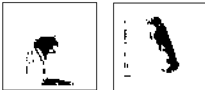
Fig.17 : Seuillage de l'ombre avec un seuil adaptatif
