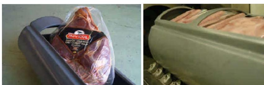
**Figure 6 :** Paniers de remplissage de l'enceinte contenant des produits à pressuriser.
