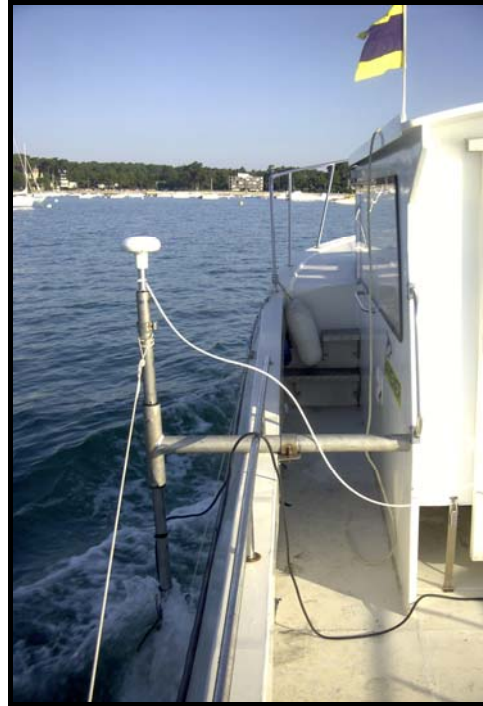
Figure II-28 : Gréement de l'ADCP et du GPS sur le bateau
