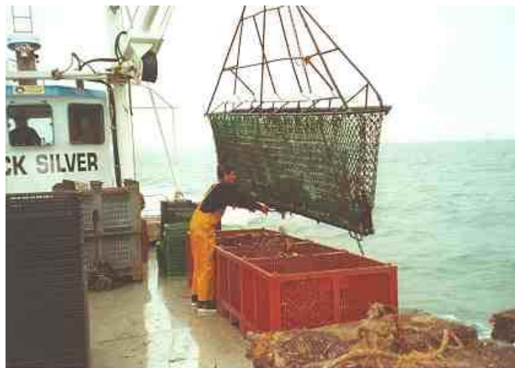
Figure 4 : Exemple de draque utilisée en ostréiculture en eau profonde
