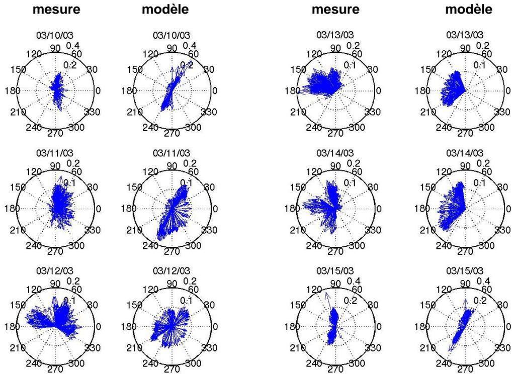
**Figure 3** : Courants mesurés par la station Sample en morte eau (du 10 au 15 mars 2003, colonnes 1 et 3) et courant simulé par le modèle aux mêmes dates (colonnes 2 et 4). Vent de Sud-Ouest les 10 et 11 mars, virant de l'ouest à l'est par le nord le 12, et vent d'est du 13 au 15 ; intensités de 7 à 10 m.s<sup>-1</sup>.
