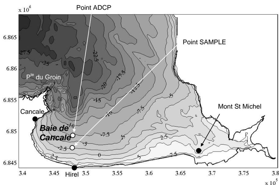
**Figure 1 :** Bathymétrie. Les coordonnées sont données dans la projection Lambert 93, et les hauteurs d'eau se réfèrent au niveau moyen.
