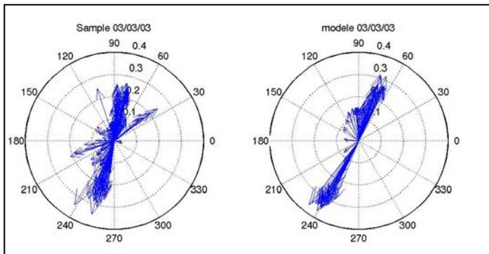
**Figure 4** : Courant mesuré par Sample (point SAMPLE, à gauche) et simulé par le modèle (à droite), le 3 mars 2003 (coefficient 91).
