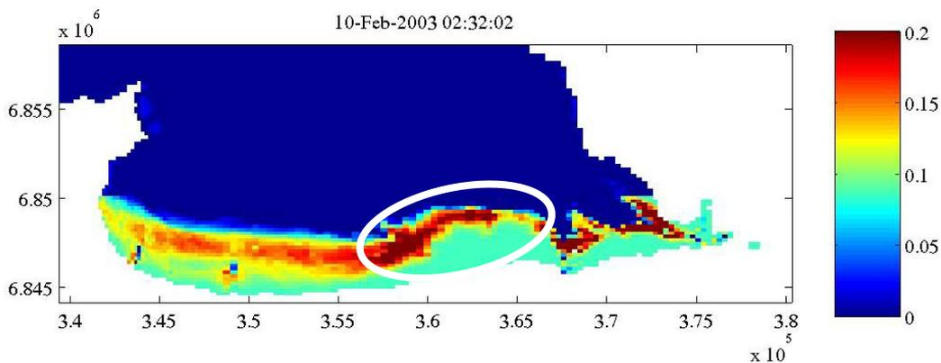
**Figure 6** : épaisseur du dépôt de vase en mètres après 40 jours de simulation (l'ellipse souligne la zone de forts dépôts mentionnée dans le texte).
