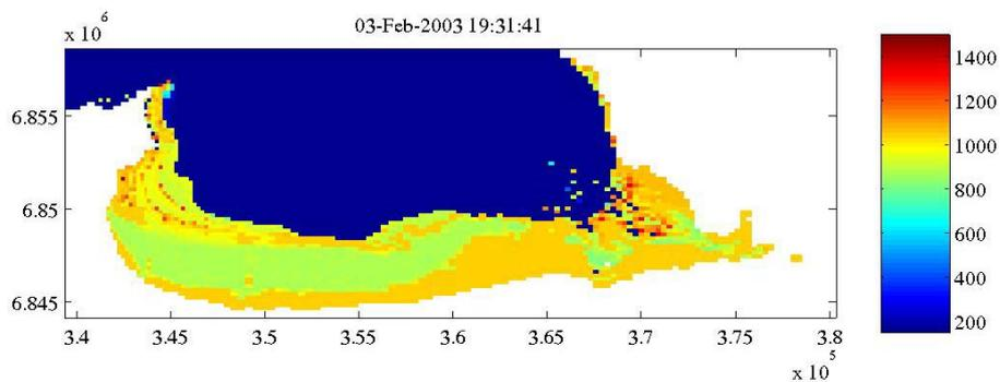
**Figure 7** : Concentration du sédiment de surface (en  $\text{g.l}^{-1}$ ). Les valeurs inférieures à  $400 \text{ g.l}^{-1}$  concernent des zones où aucun dépôt de vase n'est simulé. Par ailleurs, des dépôts frais peuvent apparaître temporairement, et être érodés à la marée suivante.
