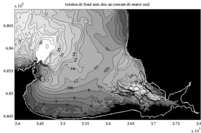
**Figure 2** : Tension sur le fond maximales calculées en vive eau ( $N.m^{-2}$ )
