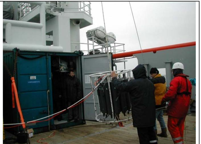
*Mise à bord de la bathysonde en fin de profil. On aperçoit le câble technique qui permet le contrôle des instruments et l'acquisition des données.*
